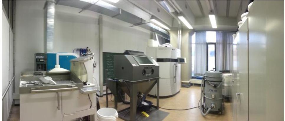
SLS-Arbeitsraum des 3D-Labors (v.l.: Auspack- & Mischstation, Glasperlstrahlanlage, Selektives Lasersinter-System EOS). Foto: TU Berlin / 3D-Labor
