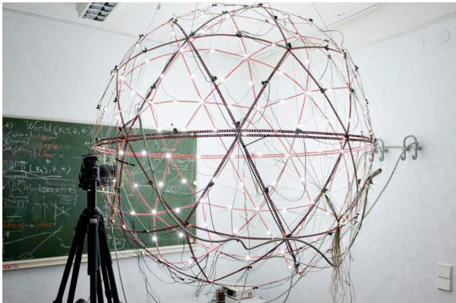
Mithilfe dieser Lichtkugel entwickeln die Forscher des Max-Planck-Institutes für Informatik in Saarbrücken ein Programm zur Gesichtserkennung. Sie erzeugen unterschiedlich beleuchtete Bilder, um die dreidimensionale Struktur zu analysieren.
